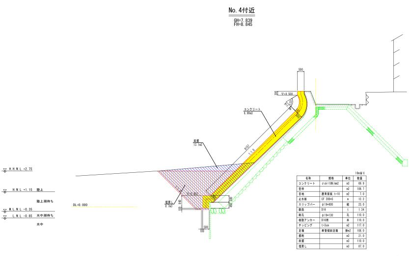
注記:破線は過去の資料及び現地踏査に基づく推定構造線であり、 施工時に現況構造物に合わせて調整を行う必要がある。 また、数量に変更が生じる場合は、必要に応じて監督員と 協議を行うものとする。
